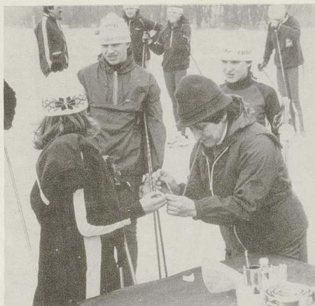
*Diagnostika únavy pomocí laktátové metody přímo v terénu*
