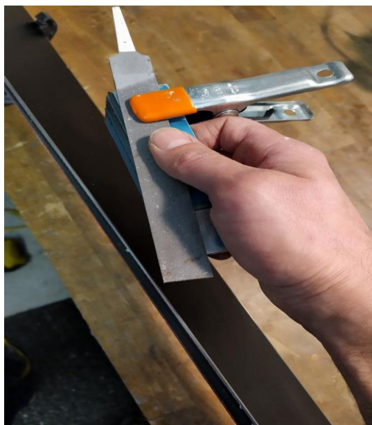
Obrázek 5: Úhelník s pilníkem (Zdroj: autor)
